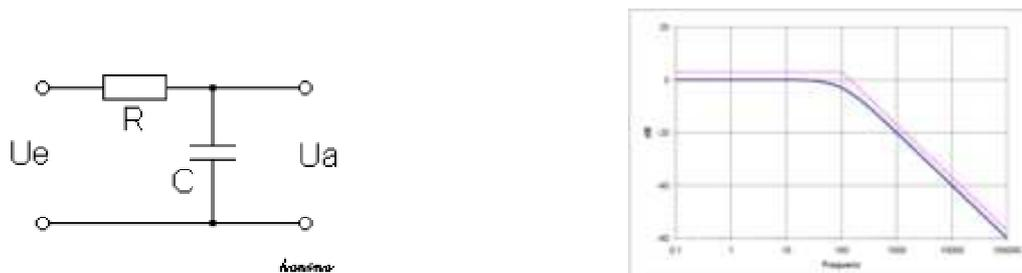
Abb. 30 passive Tiefpassschaltung mit Filterkurve<sup>47</sup>
