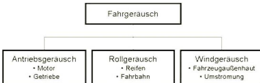
Abbildung 6: Zusammensetzung des Fahrgeräuschs. (Zeller 2009, S. 158)
