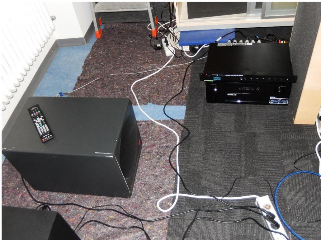
Abbildung 41: Versuchsaufbau - Subwoofer (Klein+Hummel O 818), AV-Receiver (Denon AVR-X4100W) und Symmetrierer (Tascam LA-80 MKII)
