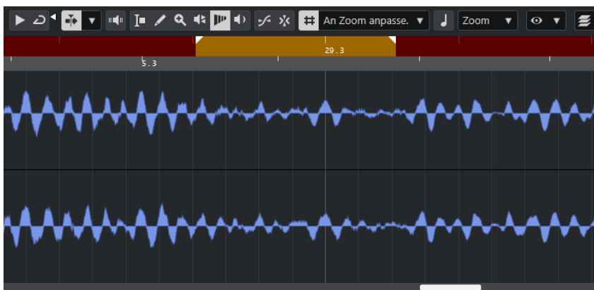
Abb. 23 - Zeigt innerhalb des orangenen Bereichs die Wellenform im Bereich des entsprechenden Artefakts. Auffällig ist ein unnatürlicher Einbruch der Amplitude. Da sich dieser Fehler weder durch Time-Stretching noch durch Clip gain (siehe Glossar) beheben ließ, wurde der Sound nachträglich bearbeitet, indem eine andere Stelle desselben Impacts beigemischt wurde.
