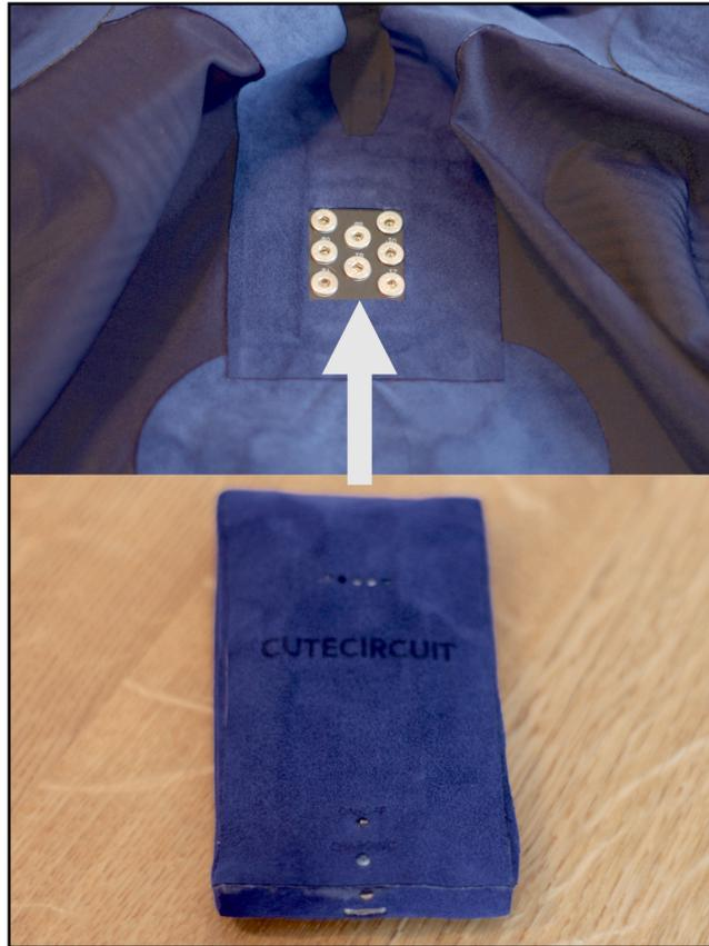
Abb. 5: Akku- und Empfängereinheit zum Aufstecken am Sound Shirt Etikett
