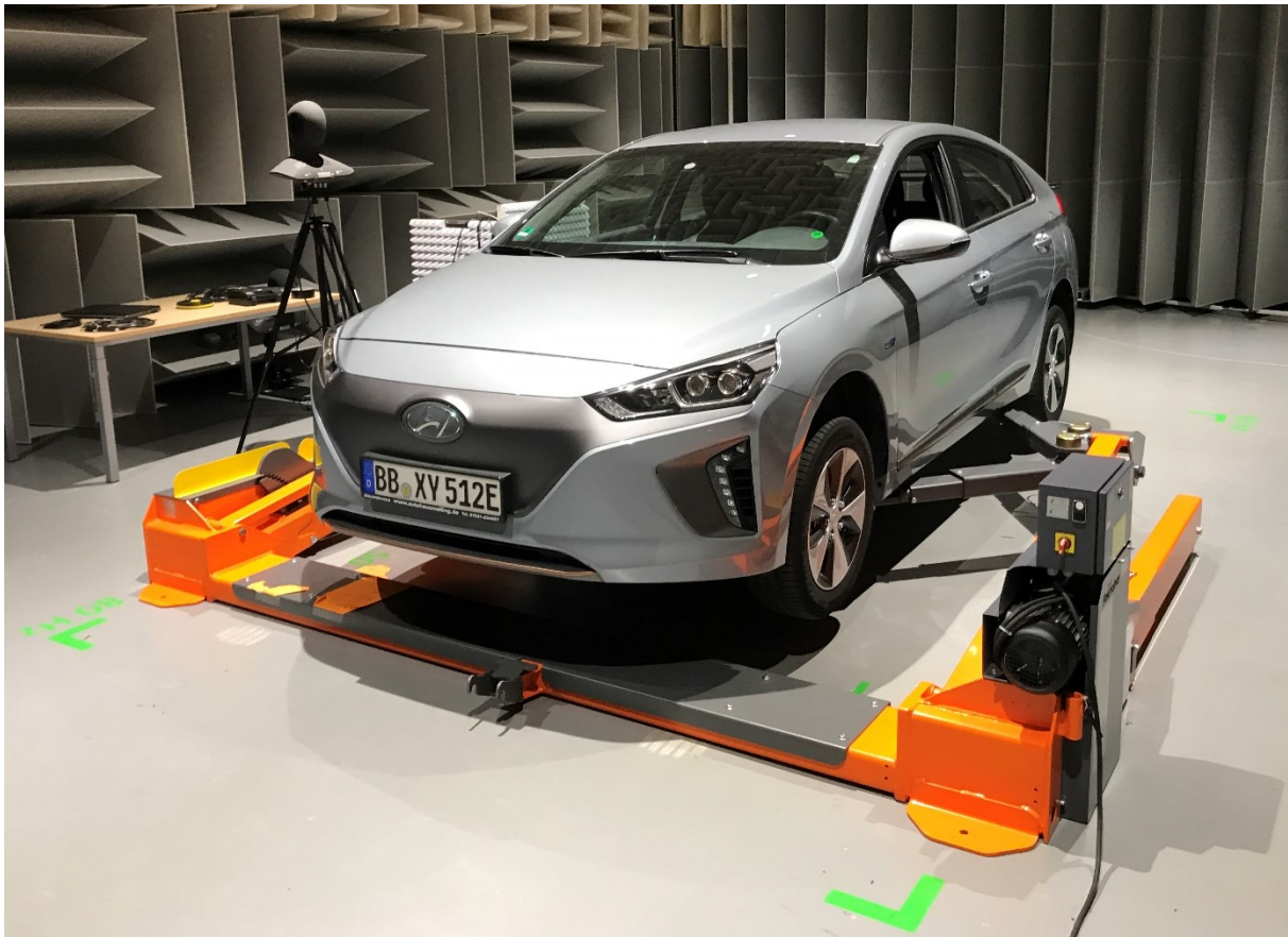
Abbildung 21: Messaufbau im Halbfreifeldraum
