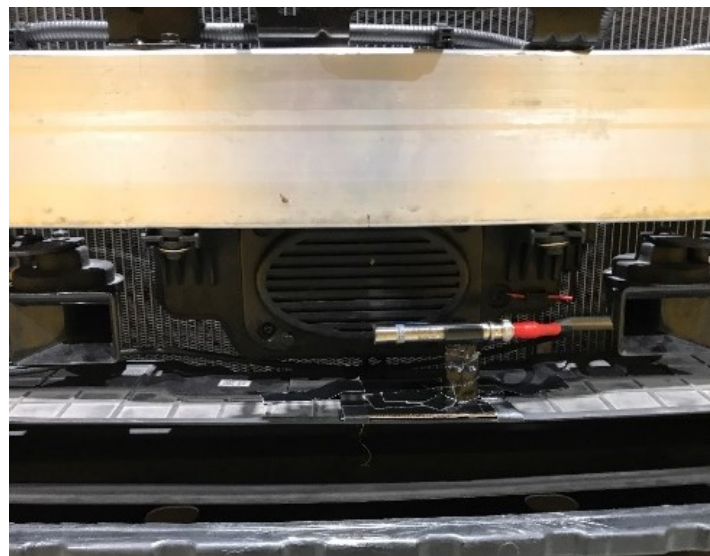
Abbildung 23: Mikrofon am Aktuator; eigene Darstellung
