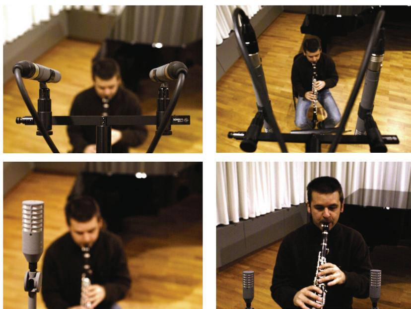
Abb. 43: Aufstellung der Klarinettenmikrofone (von links oben nach rechts unten: Stereo-Nieren-Stütze, Stereo-Acht-Stütze fern, Mono-Acht-Stütze fern, Stereo-Acht-Stütze nah)
