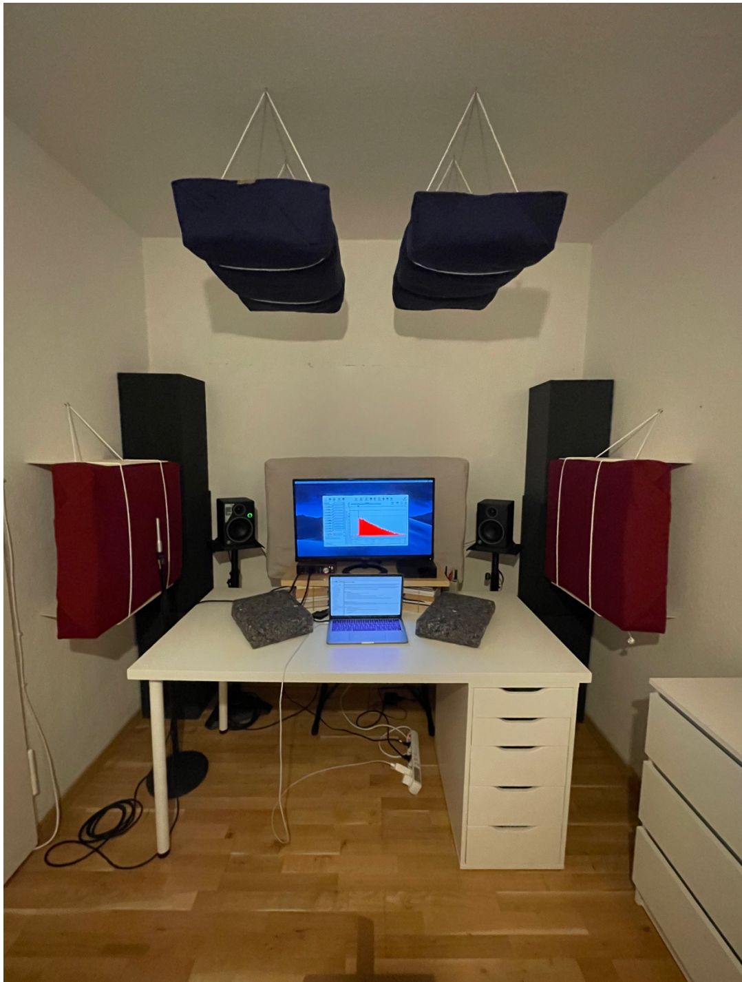
Abb. 22: Anordnung der Akustikpaneele im Abhörbereich
