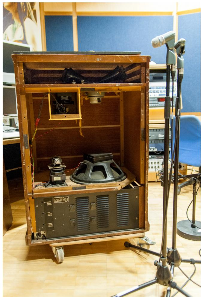
**Abb. 5:** Ein Leslie-Kabinett mit geöffnetem Gehäuse
