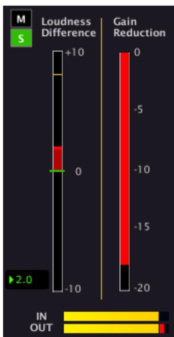
Abbildung 7.1: Loudness Difference-Anzeige zeigt Lautheitsunterschiede im Kanalzug
