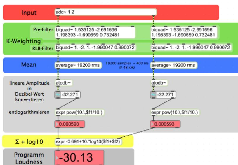
Abbildung 6.2: ITU-Algorithmus in Max/MSP für einen Stereo-Eingang
