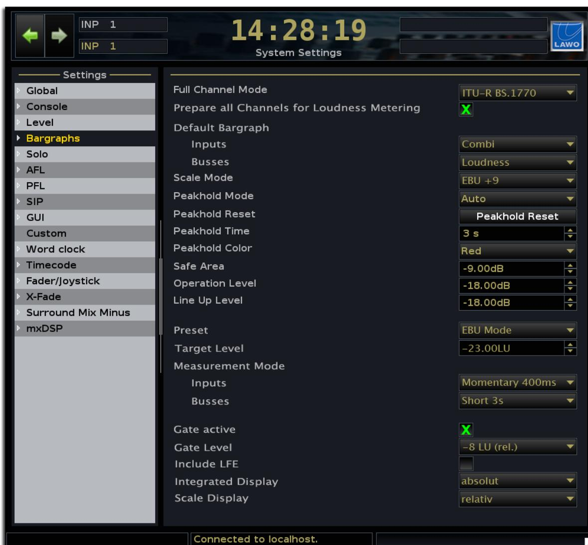
Abbildung 8.1: System Settings mit globalen Einstellung für den Lautheits-Modus
