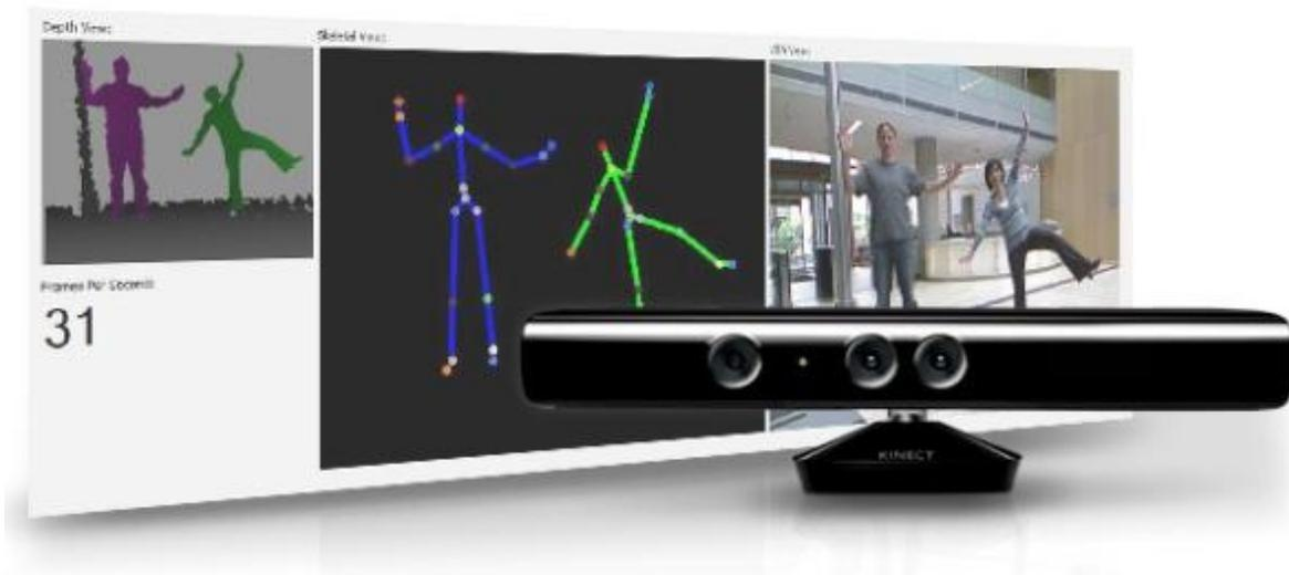
Abb. 4.16 Kinect mit Kameraerfassung und Erkennung der Körperachsen (Quelle: [37])
