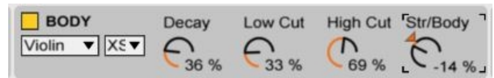
Abb.14.7) Body-Segment, simuliert den Resonanzkörper des Instruments
