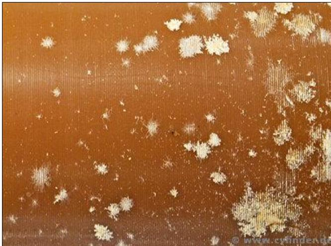
Ein brauner Wachs-Zylinder mit Schimmel-Befall, ein typisches Problem.(Quelle: [www.cylinder.de](http://www.cylinder.de))
