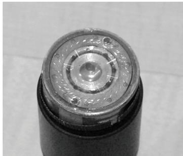
Abb. 9.13: Kapsel eines Tauchspulenmikrofons (Shure SM57)
