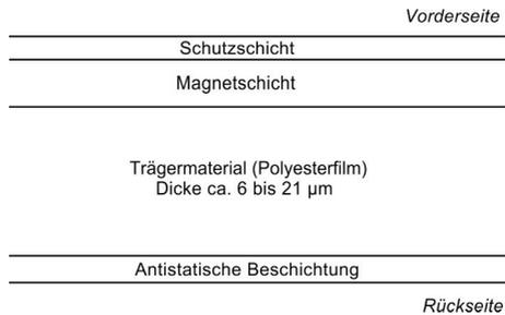
Abb. 22.44: Schnittzeichnung Magnetband
