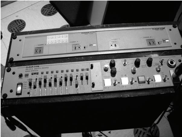
Abb. 19.5: Clearcom Master Station mit zwei Netzteilen
