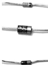
Abb. 6.26: Verschiedene Dioden
