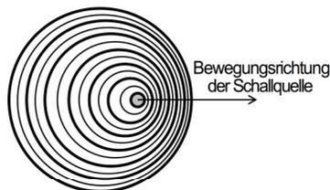
Abb. 3.9: Dopplereffekt bei einer bewegten Schallquelle
