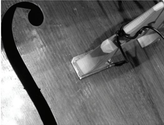
Abb. 9.15: Piezotonabnehmer unter dem Steg eines Kontrabasses
