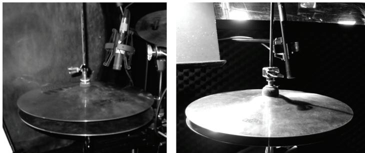
Abb. 10.4: Mikrofonierung einer HiHat
