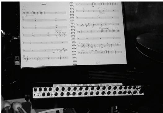
Abb. 20.12: Personalmixer (Otztronic) unter dem Notenpult
