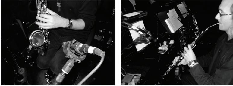
Abb. 10.10: Mikrofonierung von Saxophon und Oboe
