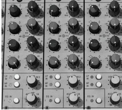
Abb. 15.13: EQ in den Kanalzügen eines analogen Pultes (Cadac F-Type)
