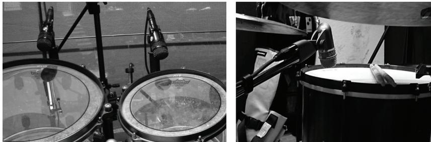
Abb. 10.3: Mikrofonierung von TomToms
