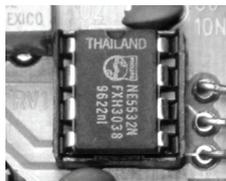
Abb. 6.45: Operationsverstärker auf einer Platine
