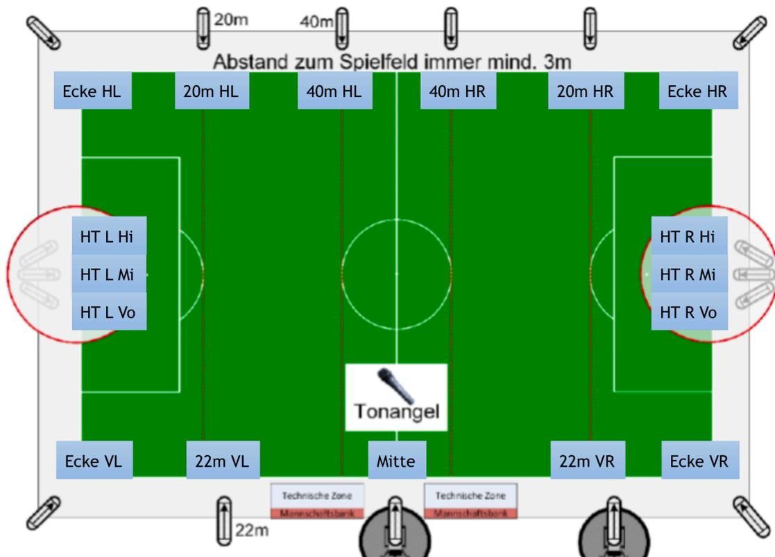
**Abbildung 7-7: Closeballmikrofon-Benennung<sup>149</sup>**
