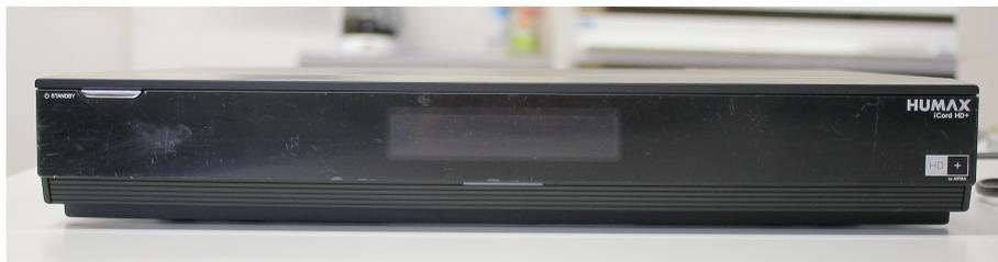
Abbildung 4.10: HbbTV Testgerät: HUMAX iCord HD+
