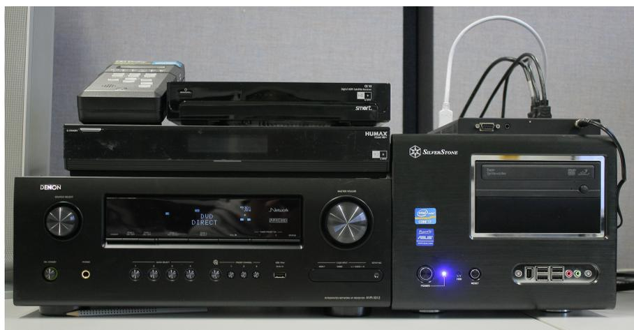
Abbildung 4.5: HbbTV Testaufbau: Denon / Transportstrom-Server
