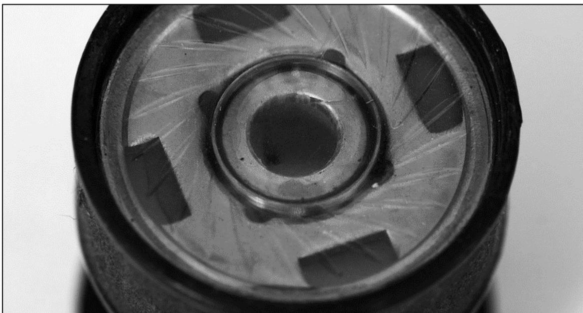
Abbildung 3-8: Eine Tauchspulkapsel mit durchsichtiger Kunststoffmembran
