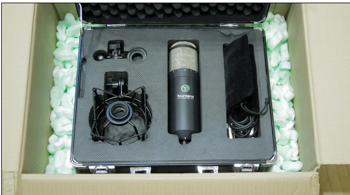
Abbildung 4-7: Das Townsend Labs Sphere L22 mit Spinne und Dual-Breakout-Kabel
