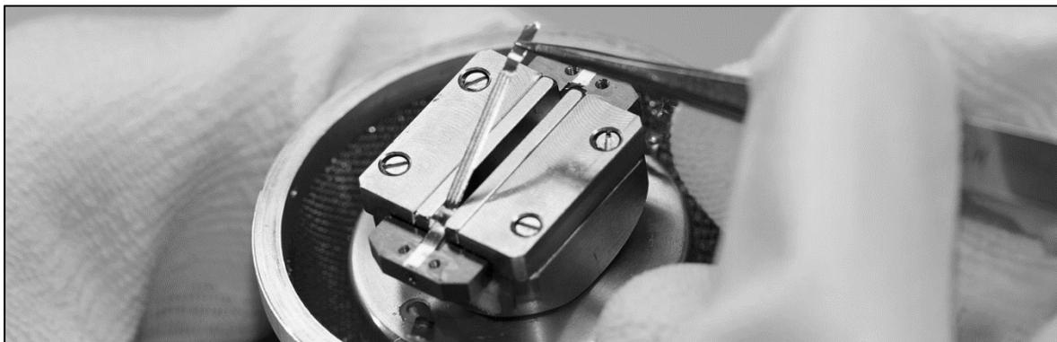
Abbildung 3-6: Bei Beyerdynamik wird ein Bändchen in eine Kapsel mit untypischer Nierencharakteristik eingesetzt
