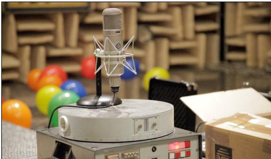
Abbildung 7-9: Der Drehteller mit dem U47 in der 0° Stellung
