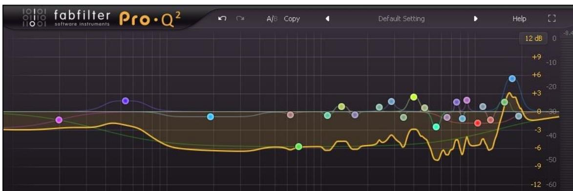
Abbildung 8-6: Ein automatisch generierter Filter um das U87 an den Frequenzgang des U47 anzupassen
