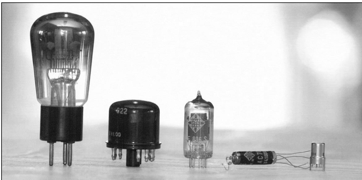
Abbildung 3-14: Links die RE086 für das CMV 3, dann die VF14 des U47 und die EF-86 und AC701, ganz rechts der Nuvistor
