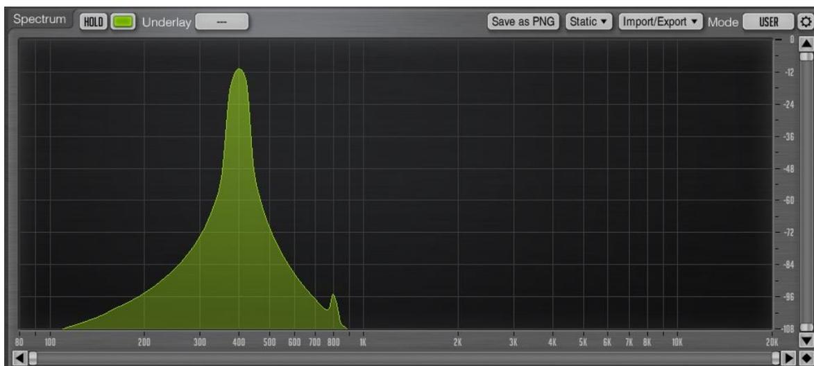
Abbildung 6-13: 400 Hz Sinus auf beiden Kanälen mit unterschiedlichem Pegel durch das Townsend Plugin mit sm57 Simulation
