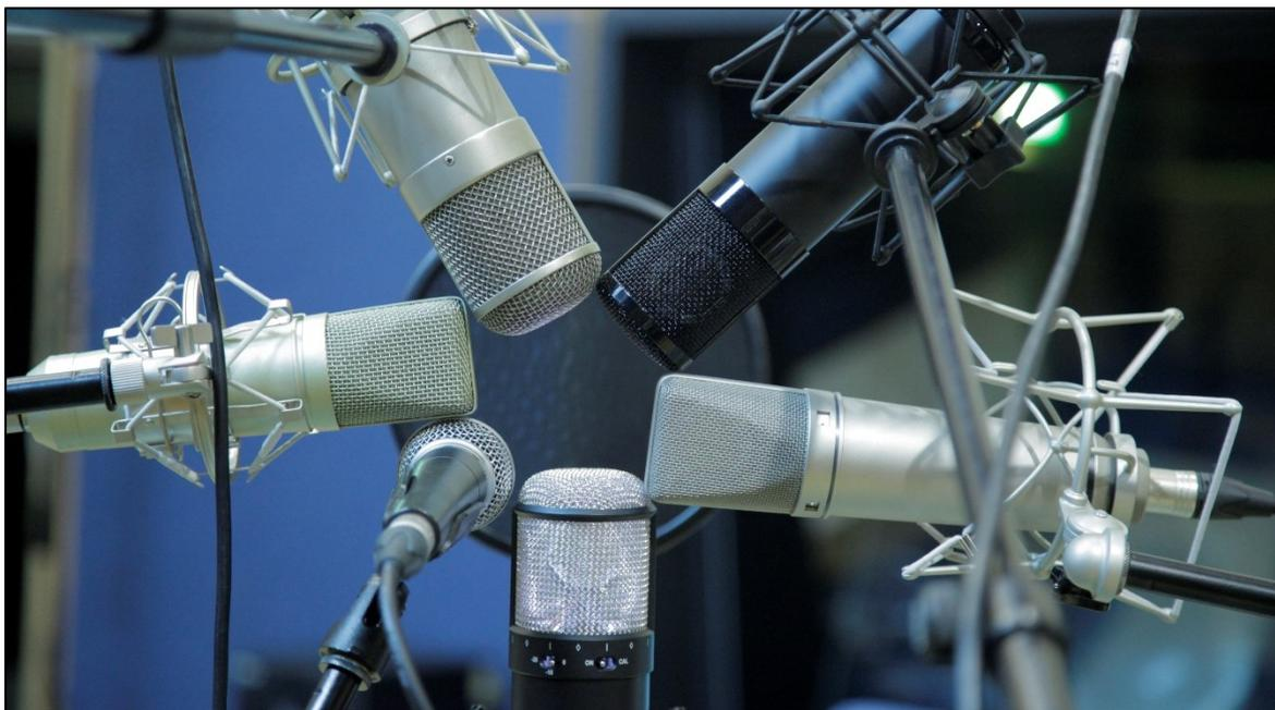
Abbildung 8-1: Von oben links im Kreis: Neumann U47, Slate VMS, Neumann U87, Townsend Labs Sphere L22, Shure sm58 und WeissKlang V13
