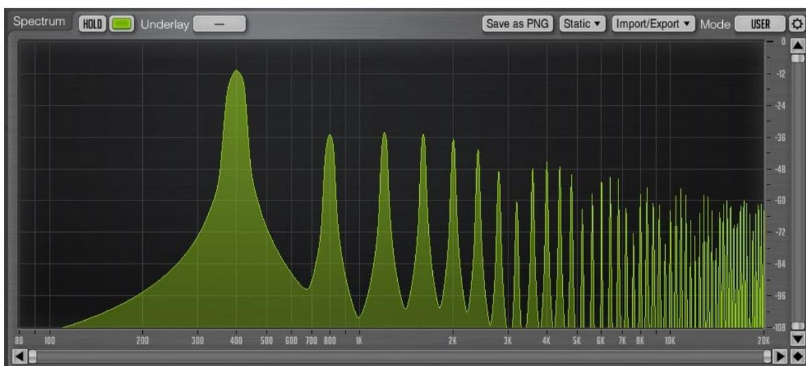
Abbildung 6-9: 400Hz Sinus durch das antares Plugin mit U87 Simulation
