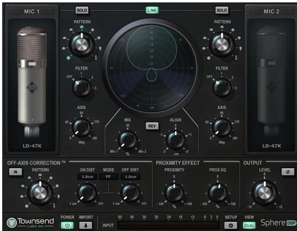
Abbildung 4-8: Das Townsend Labs Sphere Plugin im DUAL Modus
