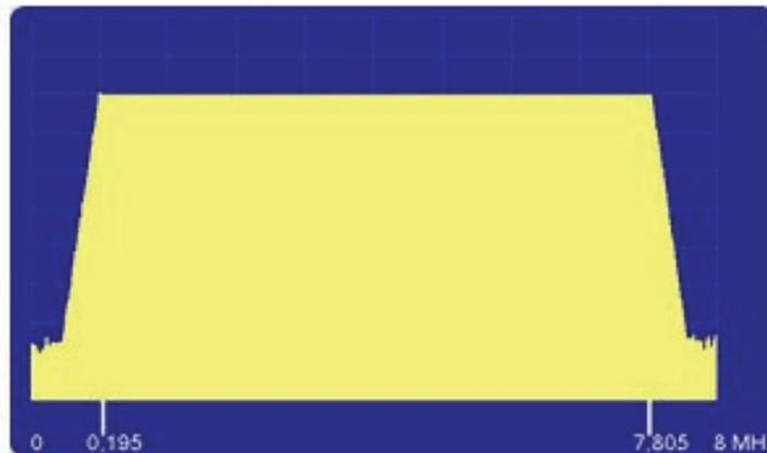
Abbildung 13: Frequenznutzung eines digitalen TV-Senders
