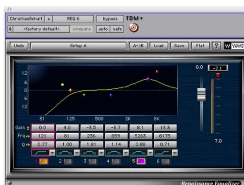
Abb. 5: Filter-Plugin zu Hörbeispiel 3 mit charakteristischer Anhebung bei etwas über 5 kHz.
