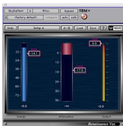
Abb. 12: Kompressor-PlugIn speziell für die Bearbeitung von Sprache. Der Grad der Verdichtung kann gewählt werden, alle anderen Parameter werden hierbei automatisch bestimmt. Zusätzlich wurde ein Gate integriert, welches Geräusche in Sprechpausen ausblendet. Die gezeigte Einstellung kam für den zweiten Sprecher des Beispiels zum Einsatz.
