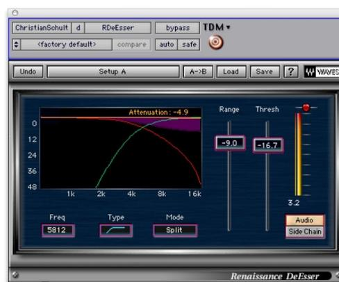
Abb. 15: DeEsser-PlugIn wie es für Hörbeispiel 35 zur Anwendung kam. Gewählt wurde für beide Sprecher die Hochpasscharakteristik mit ähnlichen Schwellenwerten, aber leicht unterschiedlichen Grenzfrequenzen.
