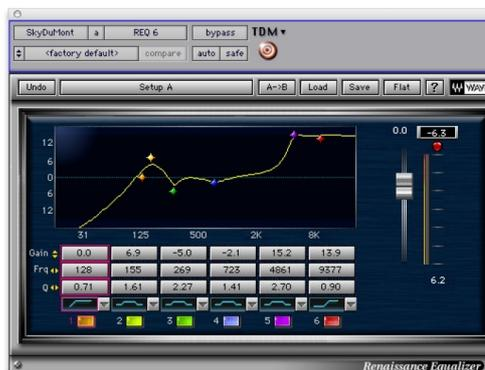
Abb. 7 und 8: Filter-PlugIns zur Entzerrung der Stimmen der Hörbeispiele 8 und 10. Sowohl die Höhenanhebungen, als auch Eingriffe in Mitten und Bässen wurden den Stimmen entsprechend unterschiedlich vorgenommen.
