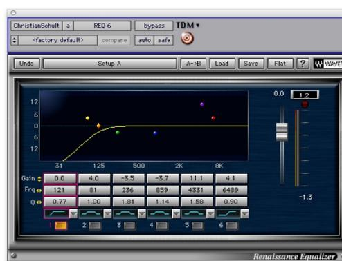
Abb. 3: 6-bandiges, vollparametrisches Filter-PlugIn. Das erste Band zeigt die Hochpasseinstellung, die für Hörbeispiel 2 zur Anwendung kam.
