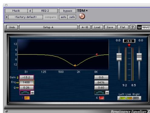
Abb. 9: Filter-Plugin mit Präsenzfilter zur Absenkung der oberen Mittenbereiche der Musik in Hörbeispiel 12.
