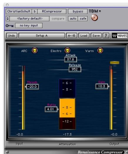
Abb. 10: Kompressor-Plugin aus Hörbeispiel 14. Das hohe Kompressionsverhältnis von 4:1 sorgt für eine gewisse Dichte des Klangs, während die eher lang gewählten Zeiten für Attack und Release die ursprüngliche Mikroynamik erhalten.
