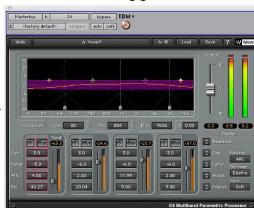
Abb. 16: Multibandkompressor-Plugin mit den Einstellungen aus Hörbeispiel 36. Anhand der orangenen Linie im oberen Teil der Darstellung wird ersichtlich, wie die Bässe und die höchsten Frequenzanteile auf Grund entsprechend gewählter Einsatzschwellen und -frequenzen (unterer Teil der Darstellung) zurückgeregelt werden.
