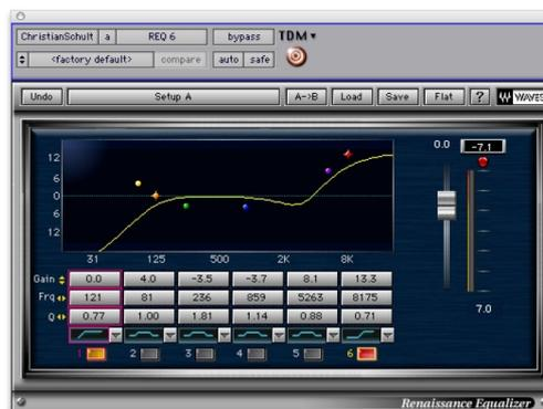
Abb. 6: Filter-PlugIn zu Hörbeispiel 5 mit Höhenentzerrer zur starken Anhebung bei 8 kHz.
