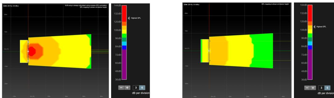
Abbildung 23: Abstrahlung der Subwoofer bei 50 Hz am Boden (links) und im Line Array (rechts) mit jeweils vier Subwoofern
