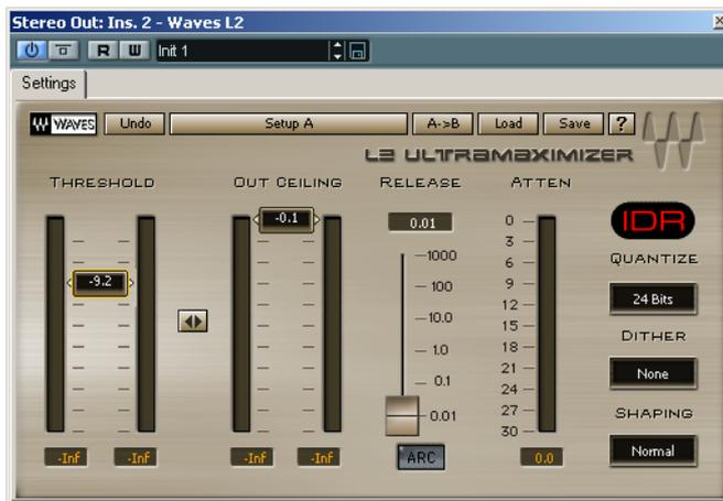
**Abb. 18** L2 Limiter von Waves
