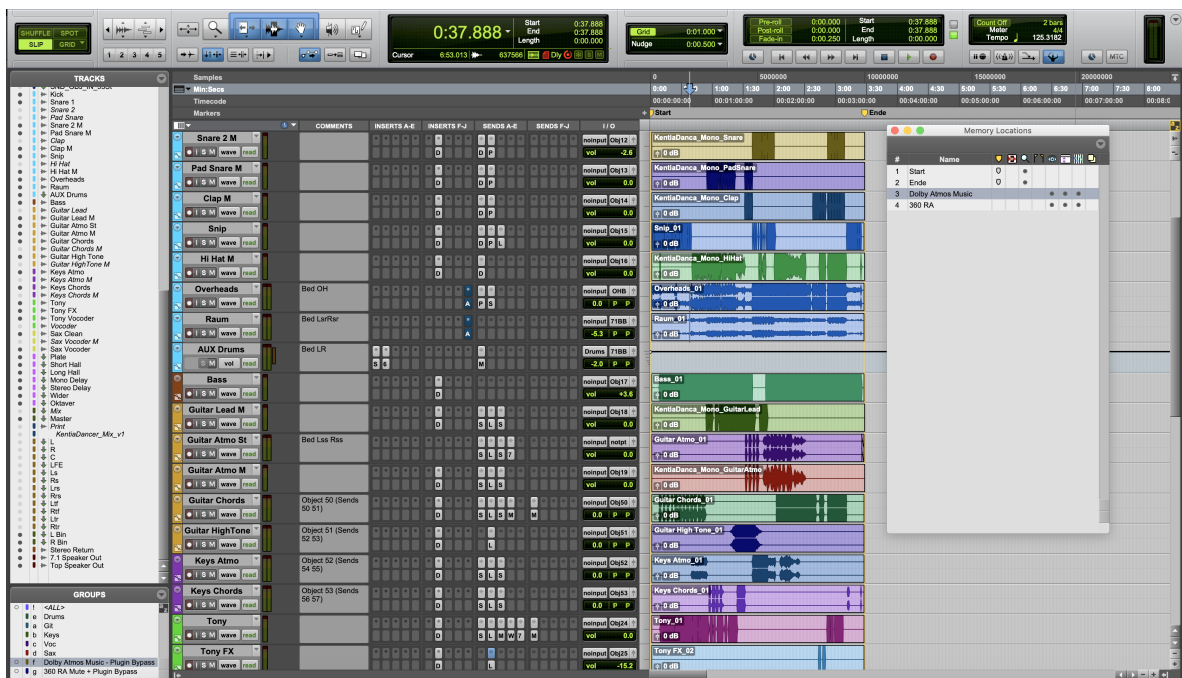
Abbildung 5.11: Kombinierte Pro Tools Session (A). Darstellung der für Dolby Atmos Music Produktion und Monitoring relevanten Spuren sowie der Gruppen (links unten), Memory Locations (rechts) und Plugin-Inserts.
