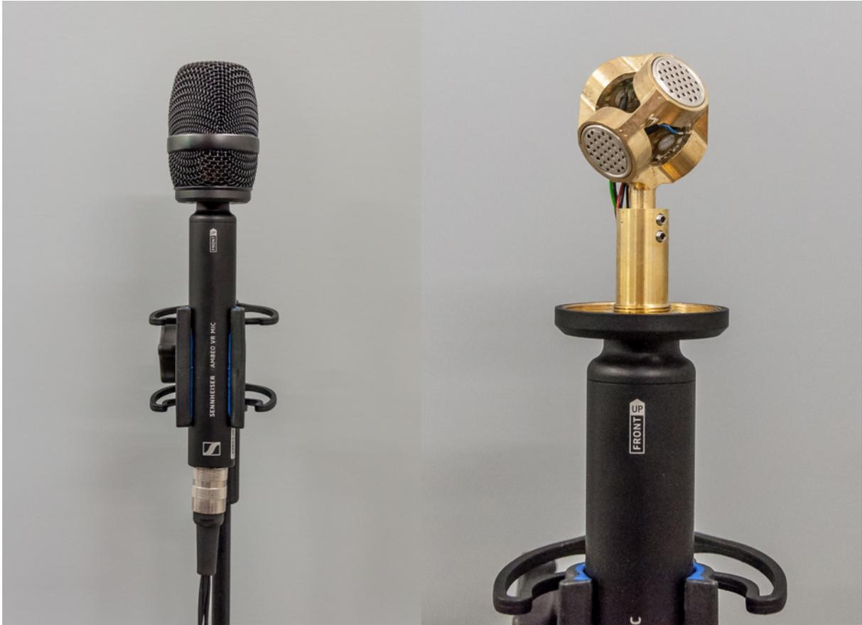
Abbildung 11 - Sennheiser AMBEO VR Mic mit (links) und ohne Korb (rechts)<sup>149</sup>
