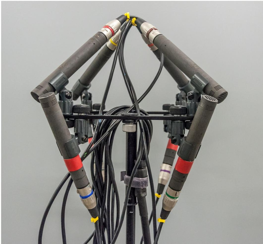
Abbildung 26 - Der komplette Aufbau des Mikrofonarrays<sup>230</sup>
