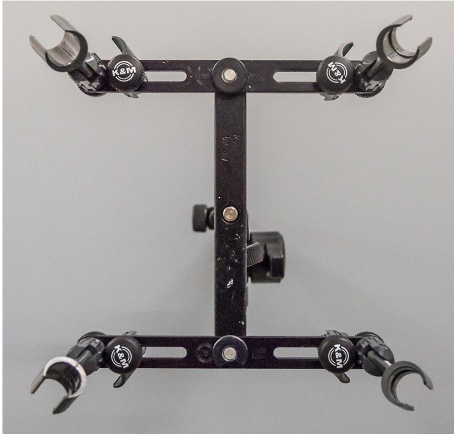
Abbildung 24 - Grundaufbau der Mikrofonschienen<sup>227</sup>
