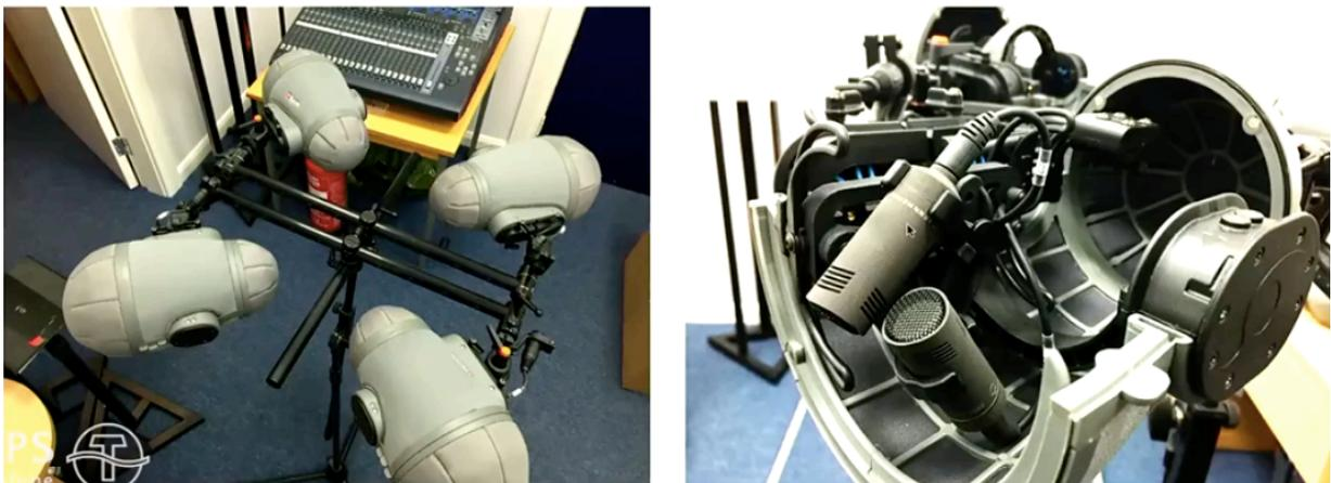
Abbildung 15 - ESMA 3D Mikrofonarray<sup>178</sup>
