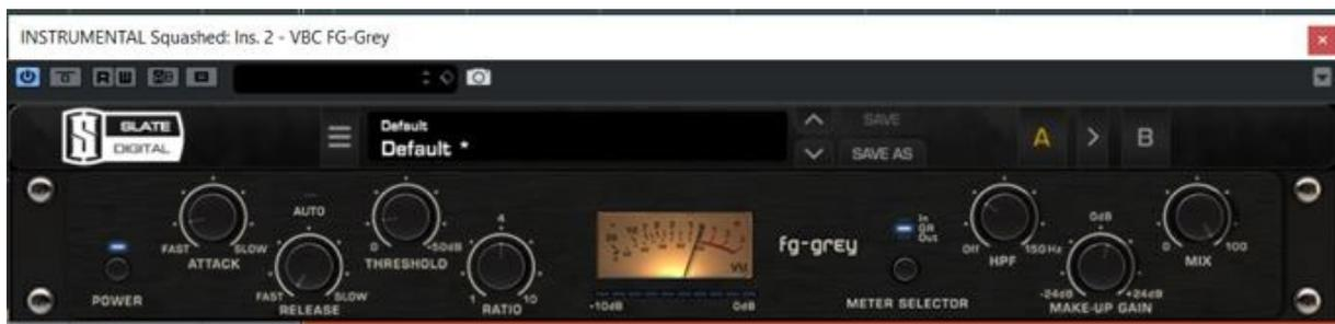
Abbildung 40: Slate Digital FG-Grey -Kompressor
