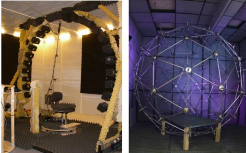
Abbildung 8: links: direkte Messung, rechts: reziproke Messung<sup>35</sup>
