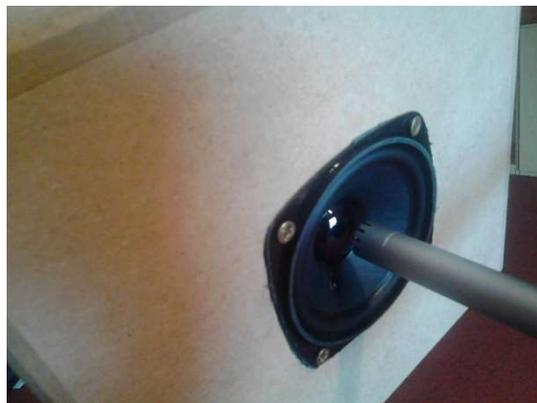
Abbildung 47. Nahfeldmessung auf der 0°-Achse.
