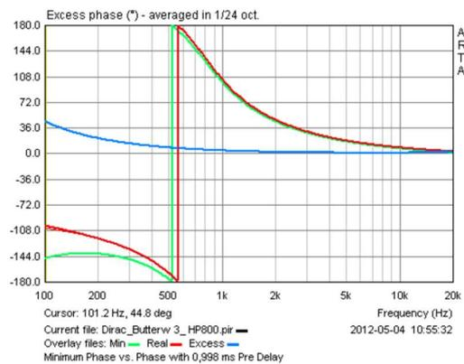
Abbildung 11. Minimalphase, reale Phase, Laufphase.
