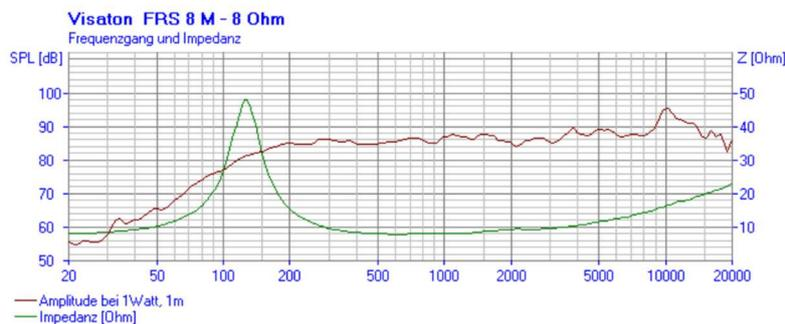
Abbildung 36. Amplituden- / Impedanzfrequenzgang.
