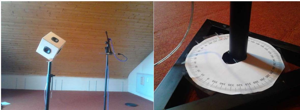
Abbildung 49. Messaufbau Rundstrahlverhalten.
