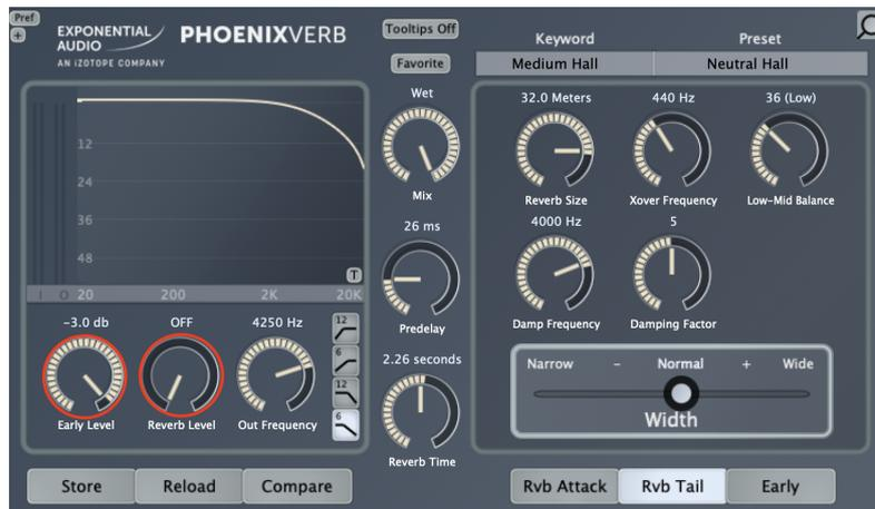
Abbildung 4.6: Stereo-Reverb mit unabhängiger Regelung von frühen Reflexionen und Nachhall
