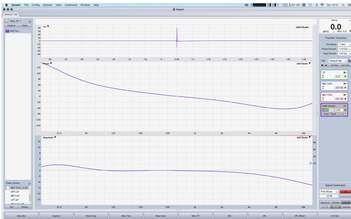
Abbildung 94: UAD A800: BIAS optimal, Treble Minimum
