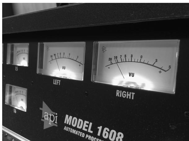
Abbildung 61: API VU-Meter einer Konsole
