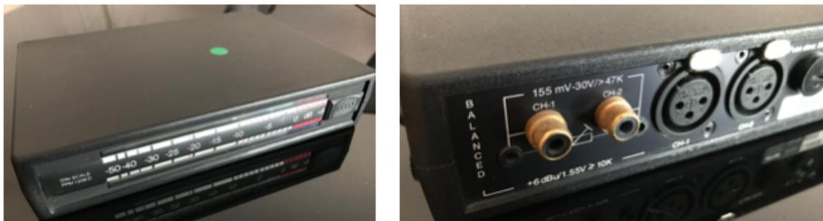
Abbildung 59: RTW PPM 1206D Pegelmessgerät
