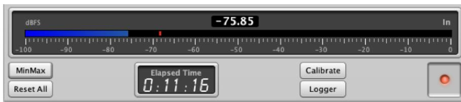
Abbildung 89: B67: Geräuschspannungsabstand bei Stop
