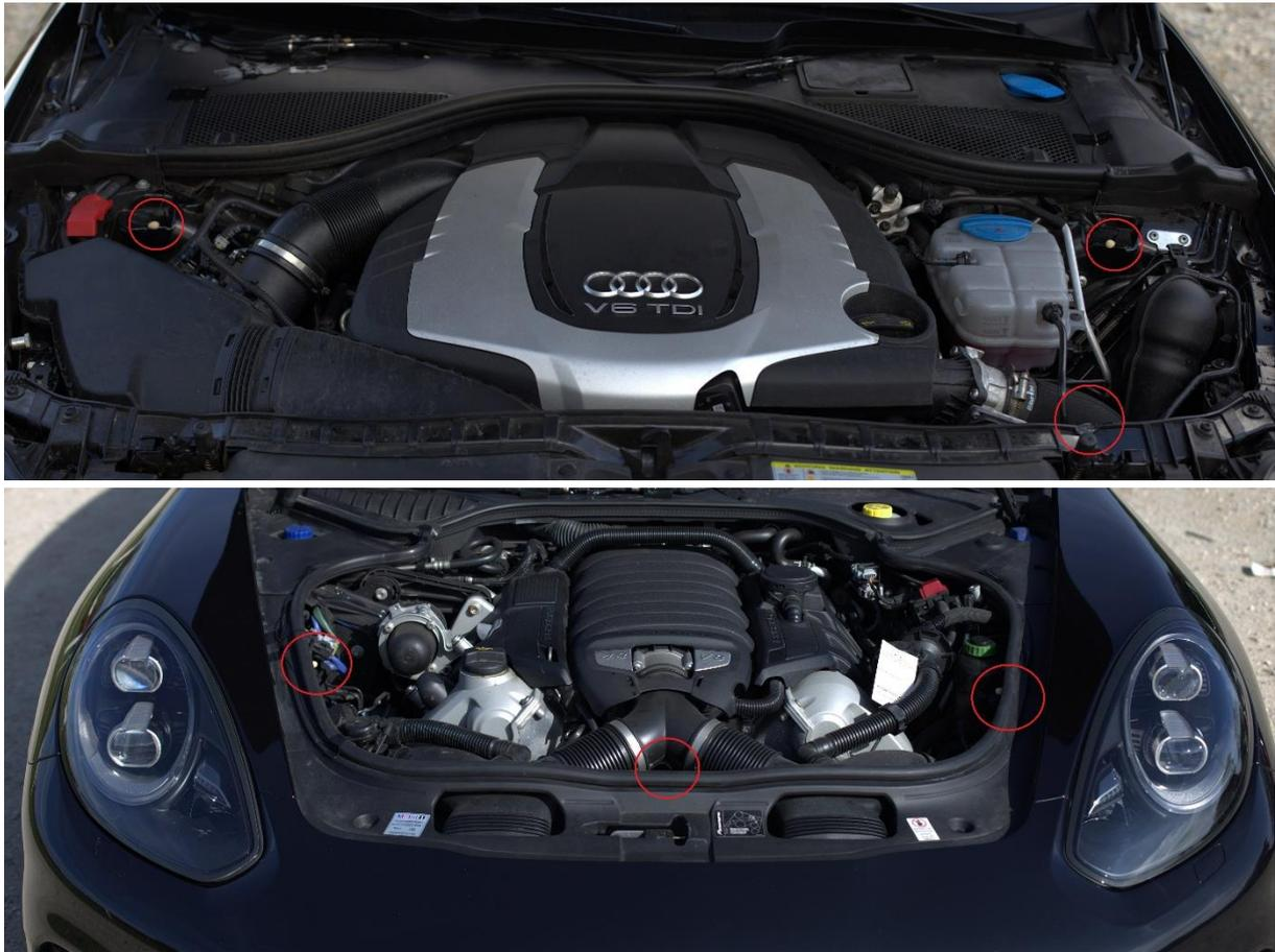
Abbildung 30: Mikrofonierung im Motorraum
