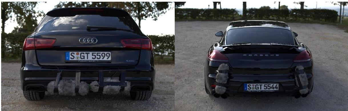
Abbildung 28: Rückseitige Mikrofonierung
