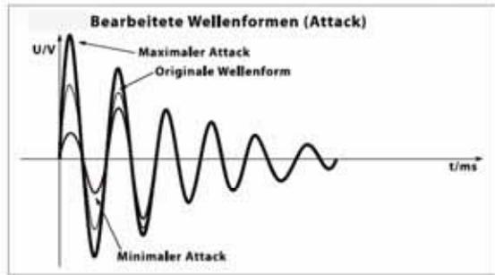
Abb. 5.4: Hüllkurvenbearbeitung Attack (aus: SPL: Bedienungsanleitung)
