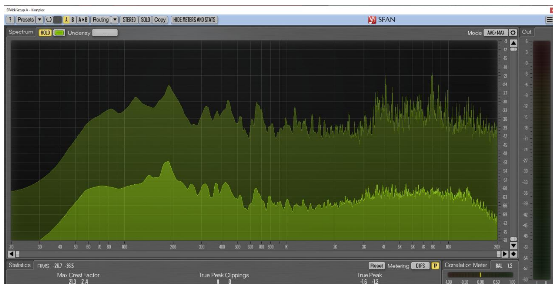
Abb. 30: Frequenzspektrum Setup A: Soundbeispiel 4 (eigene Darstellung)
