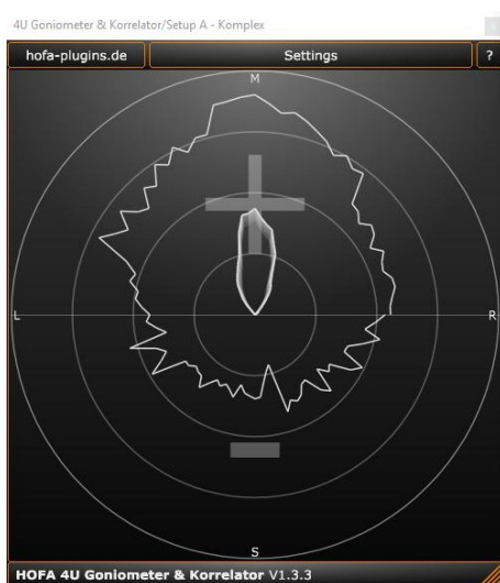
Abb. 37: Goniometer Snaredrum Setup A (eigene Darstellung)
