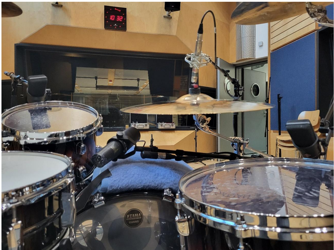
Abb. 18: Mikrofonierung Toms und Wurst-Mikrofon Setup A (eigene Darstellung)
