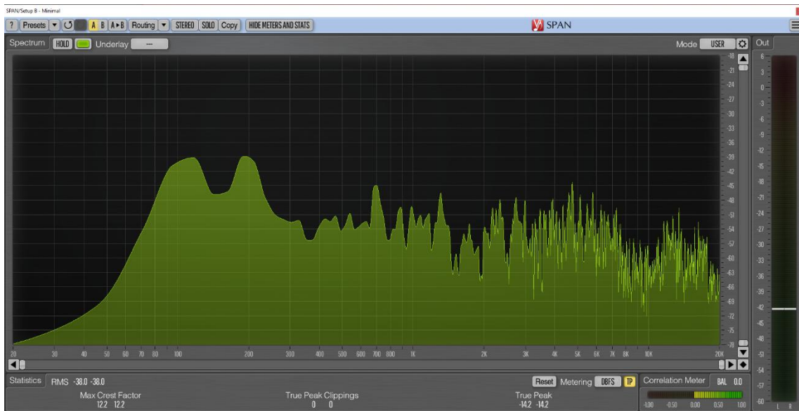
Abb. 47 Frequenzspektrum Floortom Setup B Mono (eigene Darstellung)
