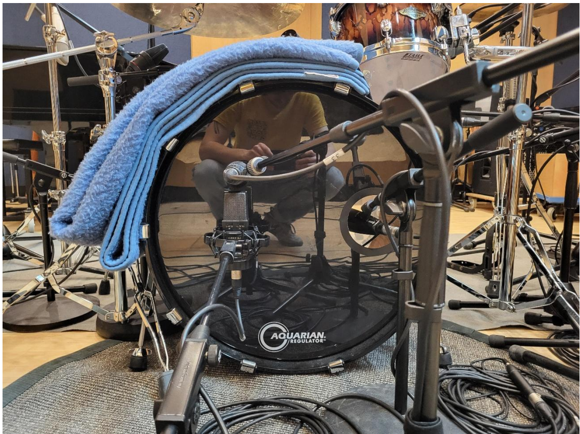
Abb. 21: Mikrofonierung der Bassdrum Setup B (eigene Darstellung)
