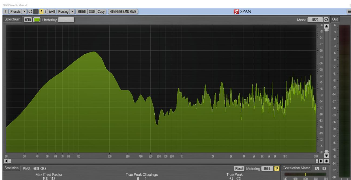
Abb. 23: Frequenzspektrum Bassdrum Setup B (eigene Darstellung)
