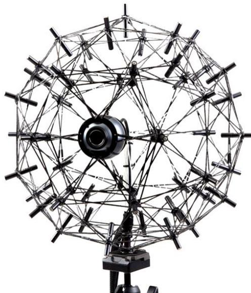
Abbildung 11: Sphere 48-35 AC Pro, Quelle: gfai tech GmbH
