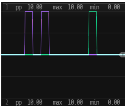
Abbildung 17: Ausgangssignale eines in Serie geschalteten Bernoulli Moduls
