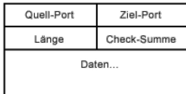
Abbildung 3-5 Aufbau UDP Header<sup>50</sup>
