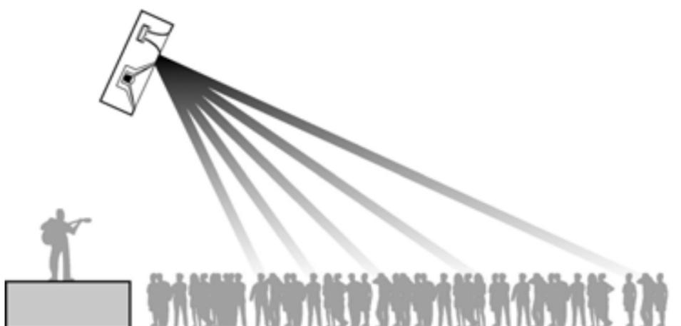
**Abb. 6.1:** Lautsprecher über der Bühne, vertikal ausgerichtet. (Schullan et al., 2014, S. 576)
