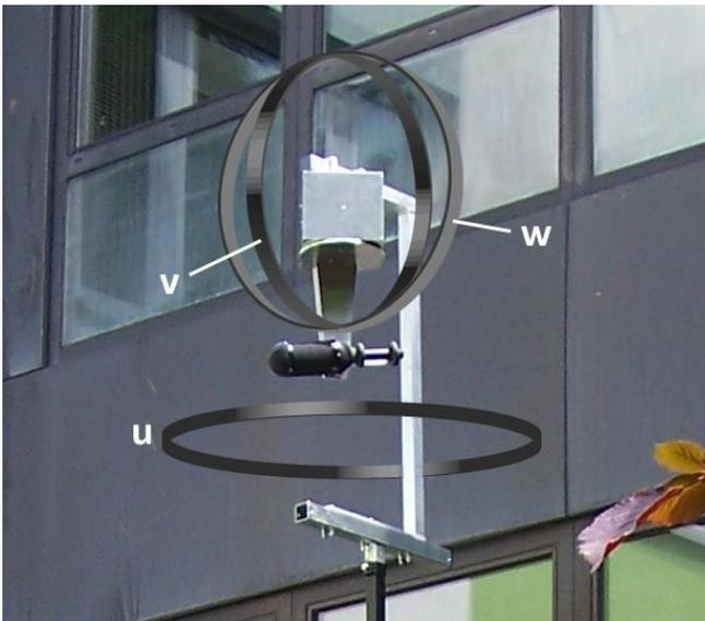
**Abbildung 21 - mögliche Verdrehung des Remote Head**
