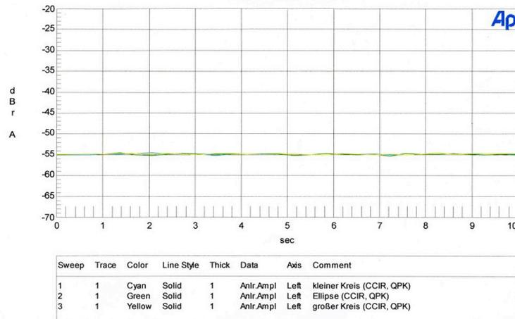
Bild 25. Ersatzgeräuschpegel bewertet nach CCIR 468-3 (äquivalenter Schalldruckpegel des Eigenrauschens:  $94 \text{ dB} - 55 \text{ dB} = 39 \text{ dB}$  (CCIR, QPK))
