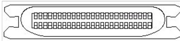
Abbildung 13: Skizze eines SCSI-1 Stecker (50 Pin)
