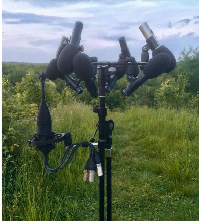
Abb. 31: „ORTF-3D Nachbau und Ambisonics A-Format-Mikrofon“, Quelle: Archiv
