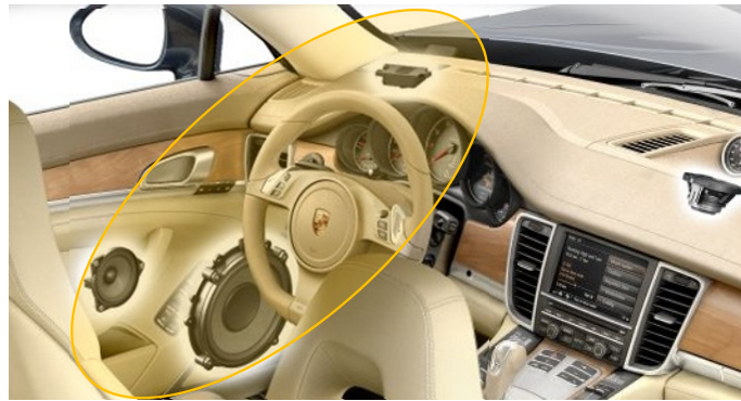
Abb. 9-2: Einbauorte des Tiefton-, Mittelton-, Hochton- und Center-Lautsprecher im Panamera G1. Gruppe 1. Quelle: Porsche
