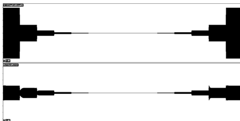
Abb. 7-4: Messsignal dynamisches Verhalten Kompressor/Limiter Oben: Eingangssignal, 1000Hz Sinus, 10dB Stufen Unten: Ausgangssignal, dynamisches Verhalten der Regelverstärker wird sichtbar. Eigene Darstellung
