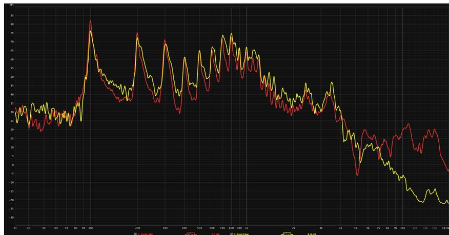
Abbildung 2.3: Frequenzspektren bei Aussprache des Buchstaben „A“ mit Grundton 95Hz, aufgezeichnet mit einem Studiomikrofon (Rot) und über FaceTime (Gelb)
