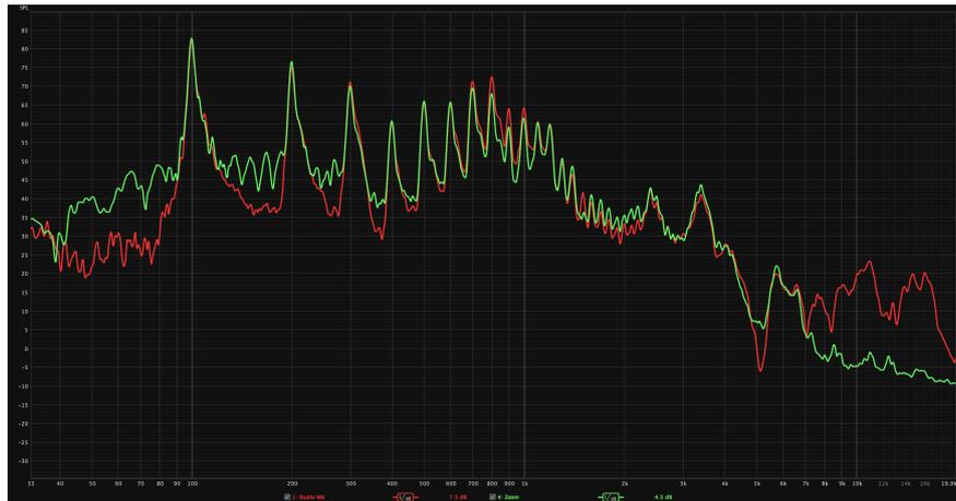
Abbildung 2.4: Frequenzspektren bei Aussprache des Buchstaben „A“ mit Grundton 95Hz, aufgezeichnet mit einem Studiomikrofon (Rot) und über Zoom (Grün)
