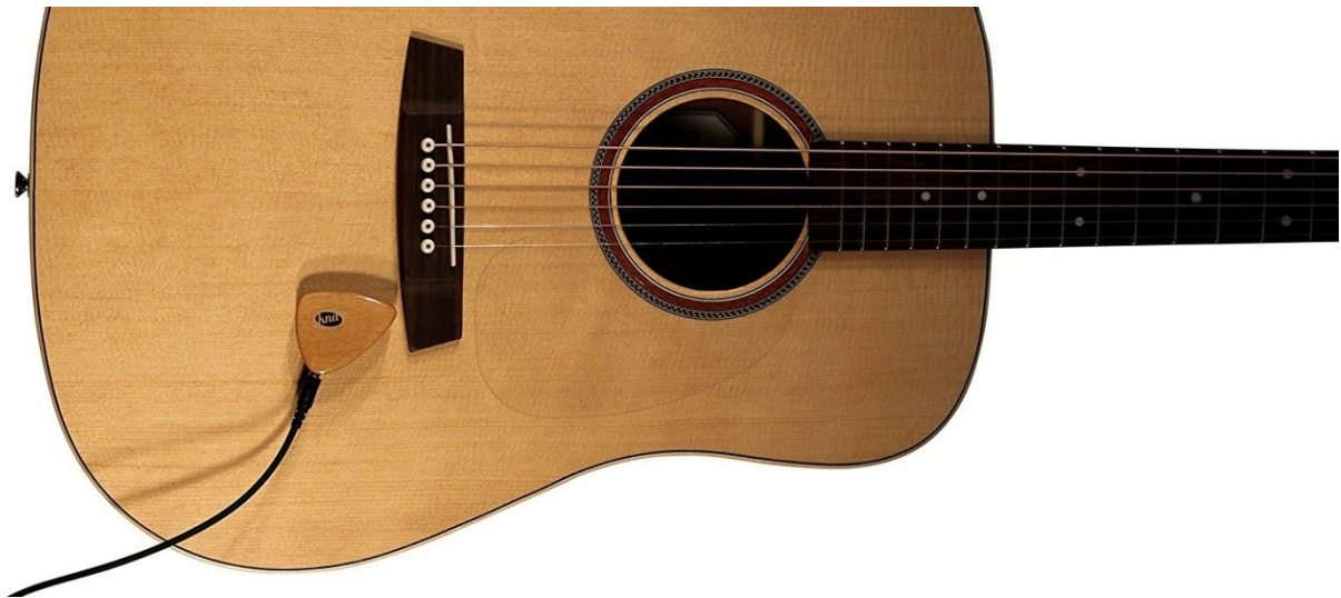
Abbildung 17 Gängige Position für ein Kontaktmikrofon, aus [9]
