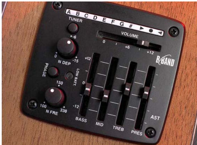
Abbildung 22 Typischer Vorverstärker in der Zarge mit Klangregelung, aus [12]
