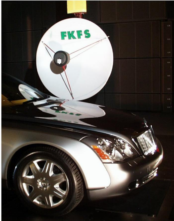
Abbildung 2.3: Hohlspiegelmikrofon in der Messstrecke eines aeroakustischen Windkanals
