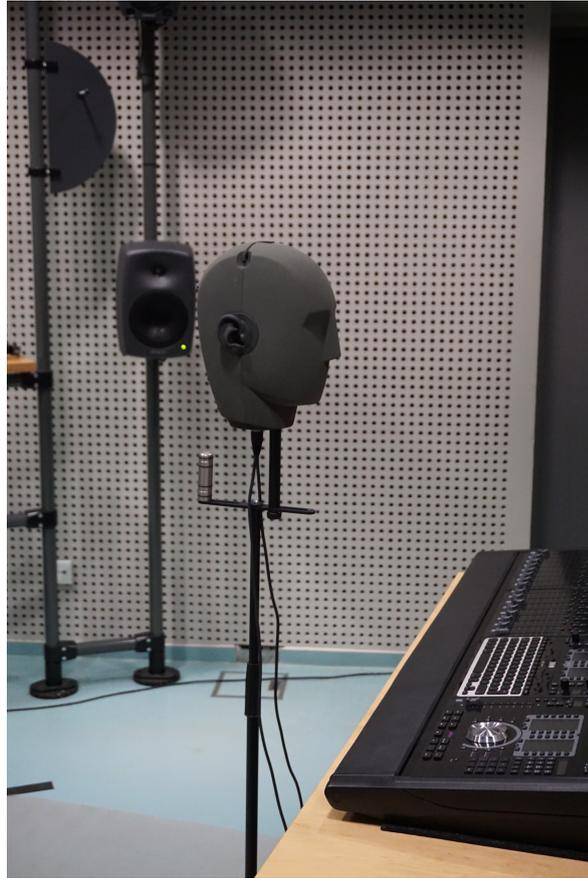
**Abbildung 5.13:** *Neumann KU 100* Kunstkopfmikrofon auf dem Drehsystem (eigene Darstellung)
