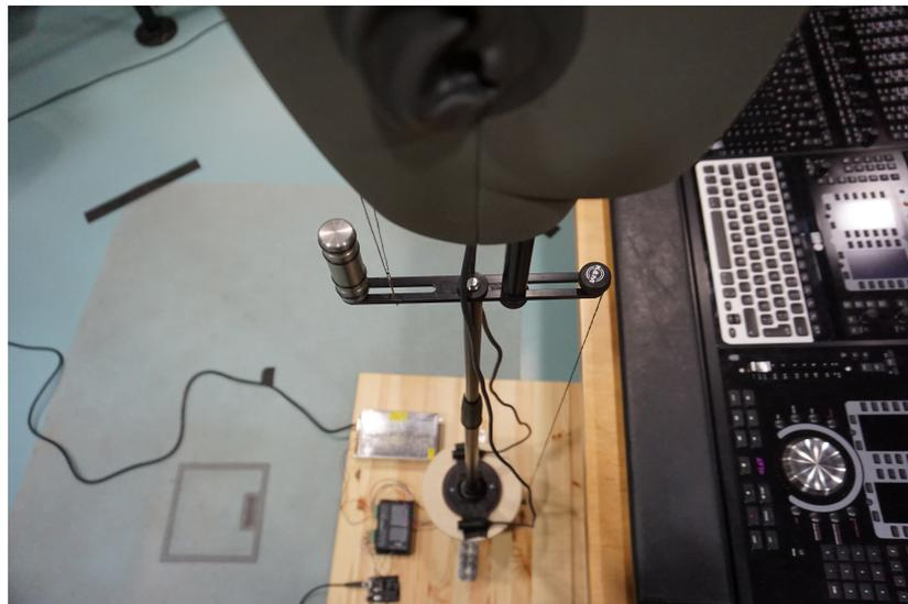
**Abbildung 5.15:** Möglichkeiten der Ausrichtung des Drehsystems mithilfe von Loten(eigene Darstellung)
