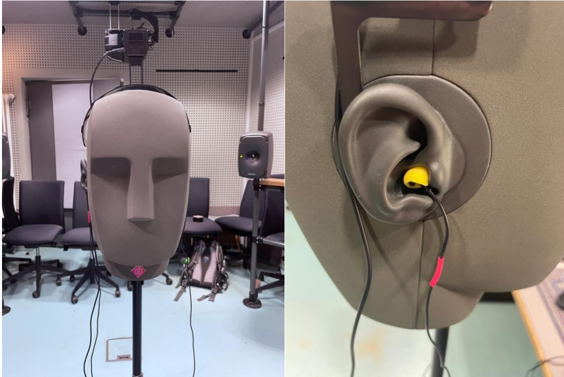
Abbildung 14 - Neumann KU100 im Messaufbau mit Headtracker (links) & Ohrmikrofone im Detail (rechts)
