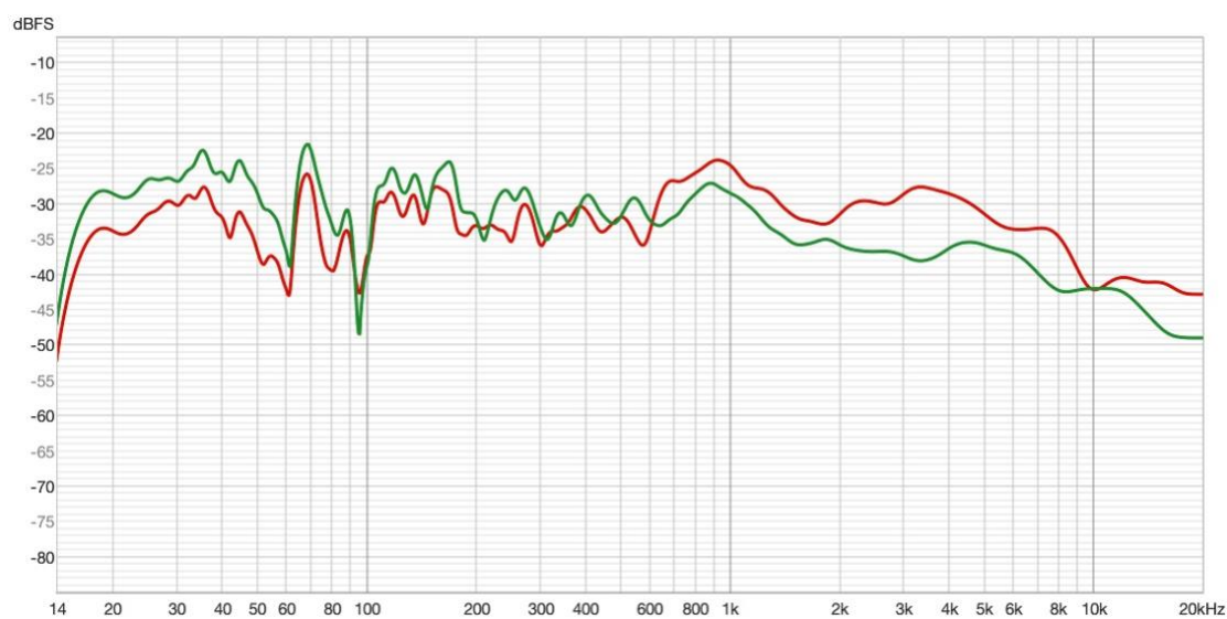
Abbildung 27 - Frequenzgang (VAR Glättung): virtuell, Left wide, 0°; linkes (rot) & rechtes (grün) Ohr
