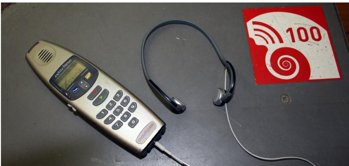
Abbildung 9: Knochenschallkopfhörer bone sonic (Grundig) am Audioguide.
