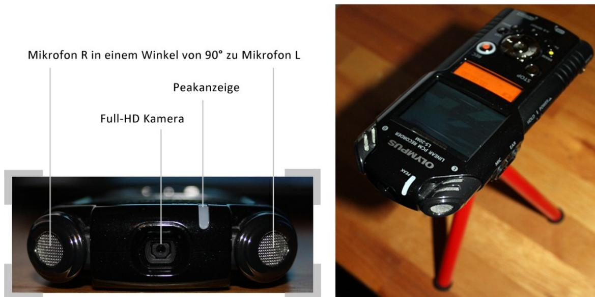
Abbildung 10: mobiler Recorder Olympus LS-20M.
