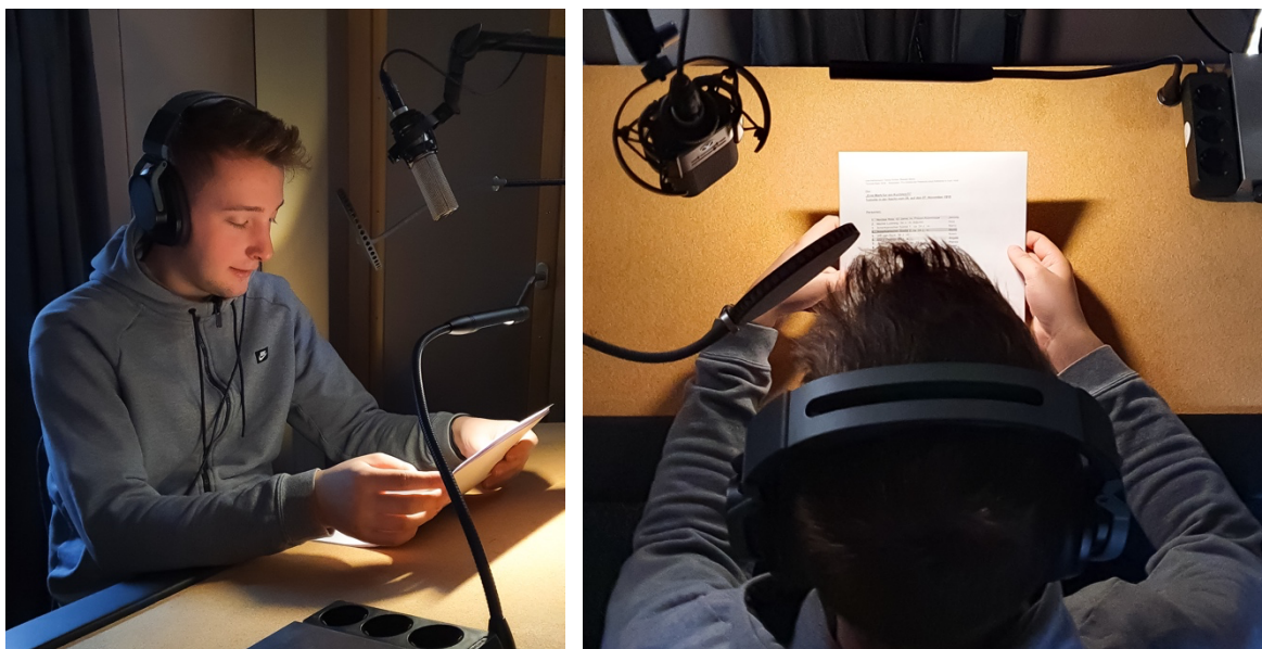
Abbildung 26 Kammfiltereffekt vermeiden: geeignete Mikrofonposition für eine Hörbuchaufnahme mit Maßnahmen gegen Störschall
