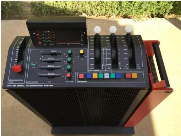
Vorreiter der digitalen Hallerzeugung war der EMT 250, das erste kommerzielle digitale Hallgerät. 1976 wurde es von der Firma Elektromesstechnik mit einem Preis von rund 50.000 DM auf den Markt gebracht und somit noch weit außerhalb des Budgets durchschnittlicher Studios lag. Dennoch stellte der 250, sowie seine Weiterentwicklung, der 251, einen wesentlichen Durchbruch in der Digitaltechnik dar, auf den auch zahlreiche andere Hersteller mit eigenen Produkten reagierten.
