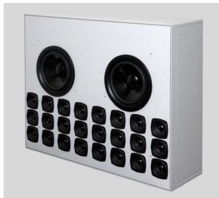
**Abb. 4.1.9:** Achtkanaliges Lautsprechermodul mit Breitbandsystemen in 10 cm Abstand und Tieftönern in 40 cm Abstand. In: Goertz u. a., *Entwicklung eines achtkanaligen Lautsprechermoduls für die Wellenfeldsynthese*
