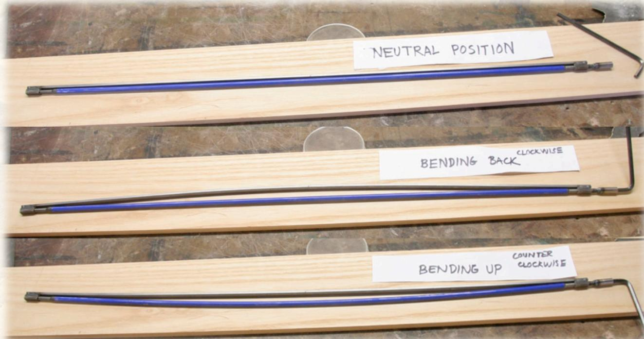
→ durch (Ent-/)Spannen: Ausgleich der Zugkraft bedingten Halskrümmung
